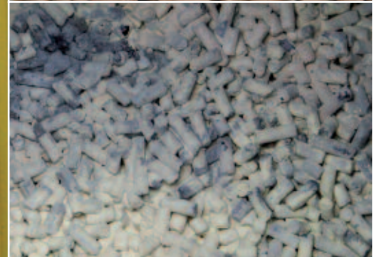
Frische, unbeladene Pellets (oben) und fast vollständig mit Schwefel beladene Pellets (unten).
